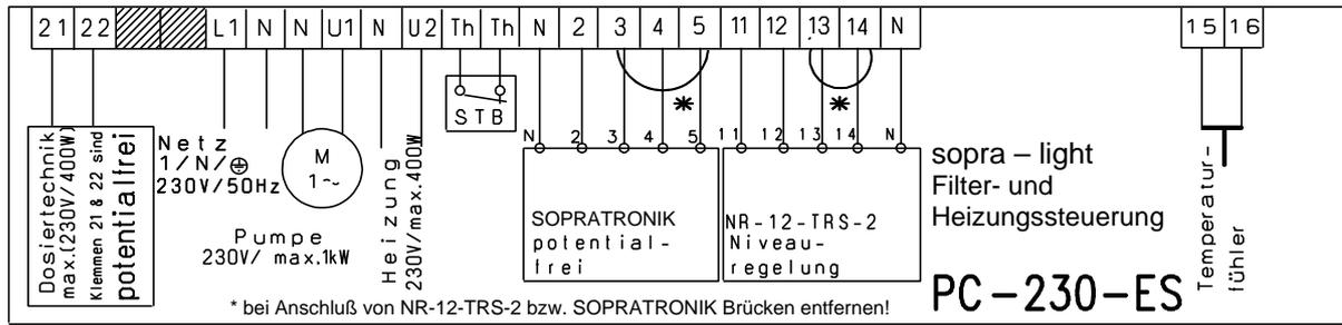
Die werksseitig eingefügte Brücke zwischen den beiden mit *Th* bezeichneten Klemmen muss bei Anschluss eines Sicherheits-Temperaturbegrenzers entfernt werden. Erfolgt kein Anschluss, dann muss sie eingeschraubt bleiben.
