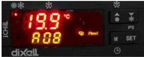
Das Display signalisiert die Forderung durch die LED oben links. Die angezeigte Wassertemperatur ist der derzeitige Ist-Wert.
